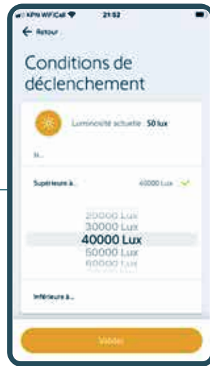
C: Les seuils de lumière (dans le cas d'une installation avec capteurs de lumière)
